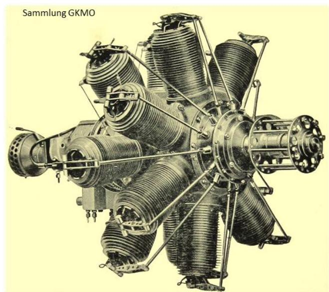
Oberurseler 14-Zylinder-Doppelstern Umlaufmotor U III mit 160 PS
